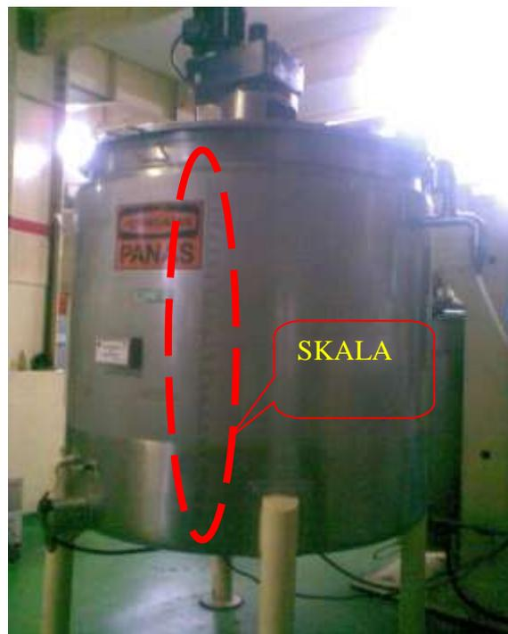
**Gambar 4. Mesin *Tempering* dengan Skala**
